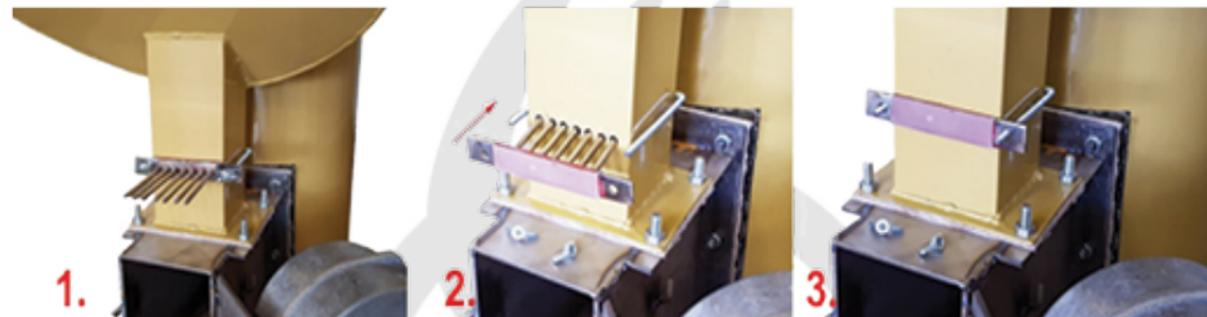
Рис. 7. Перекриття надходження пелет
